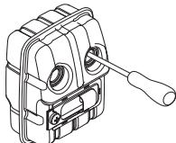
Если глушитель на вашей машине дополнительно оборудован искрогасящим фильтром, его следует регулярно прочищать. Забившийся фильтр может вызвать перегрев двигателя и привести к серьезным повреждениям двигателя.
