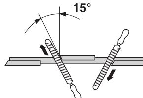
Отрегулируйте разводку. Она должен составлять 1 мм.
