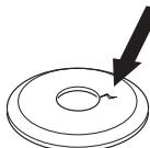
Проверьте, чтобы контргайка не потеряла своего усилия. Фиксирующее усилие гайки должно быть как минимум 1,5 Нм. Гайку следует затягивать с усилием в 35-50 Нм.
