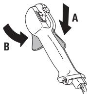
Проверьте, чтобы ручка газа в момент возвращения блокировочного рычага в исходное положение была блокирована на холостом ходу.
