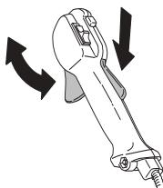
См. указания в разделе Запуск. Включите машину и полностью откройте дроссель. Отпустите рычаг дросселя и удостоверьтесь, что режущее оборудование останавливается и остается неподвижным. Если после постановки дросселя в положение холостого хода режущие оборудование продолжает вращаться, следует проверить регулировку холостого хода
